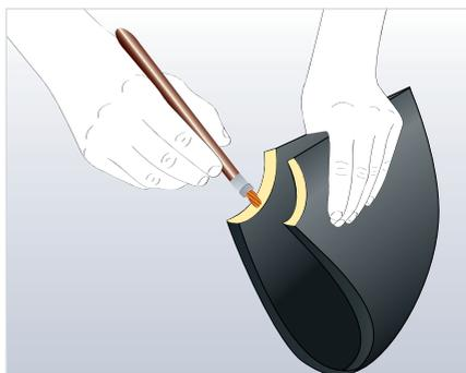
Das verklebte Formteil umdrehen und die Klebnaht von der Innenseite fest zusammendrücken, damit über die gesamte Dämmstoffdicke hinweg eine gute Klebeverbindung erzielt wird.
