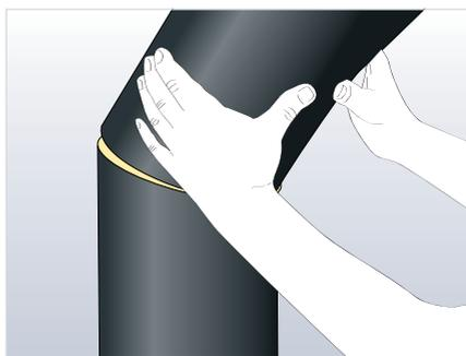
Erst die Längsnaht und dann die Verbindungsnaht mit Armaflex Kleber verkleben.
