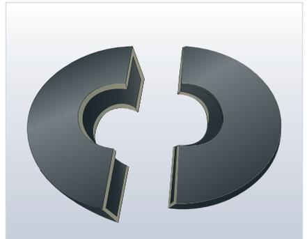
Mit einem kleinen, scharfen Messer eine Öffnung mit dem Durchmesser des gedämmten Rohrs ausschneiden.
