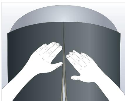
2. Den Umfang auf eine Armaflex Platte übertragen und passgenau zuschneiden. Eine dünne Schicht Kleber auf die Armaflex Platte und dann auf die Metalloberfläche auftragen. Nach dem Ablüften (Fingerprobe) die Armaflex Platte anlegen und fest andrücken, um einen guten Halt zu erzielen. Die Armaflex Mantelplatte zur Verklebung ca. 10 bis 20 cm (abhängig von der Behältergröße) über der Schweißnaht im Bereich der Rundung des Behälterkopfes ansetzen.
