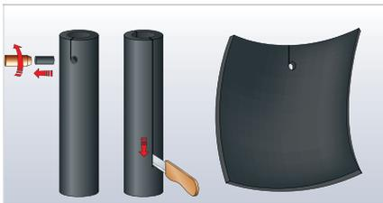
2. In einem Schlauchstück in der zu verwendeten Dämmschichtdicke mit einem geschärften Rohrstück eine entsprechende Öffnung für die Gewindestange stanzen. Schlauch im Bereich der Öffnung und der Länge nach aufschneiden.
