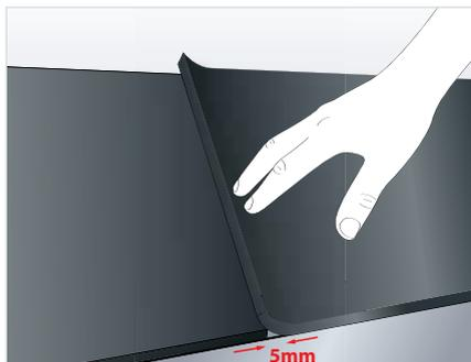
Die zugeschnittenen Anschlussplatten ca. 5 bis 10 mm überlappen lassen (für Verarbeitung auf Druck). In diesem Bereich die Armaflex Platte oder die Kanaloberfläche nicht mit Kleber einstreichen. An der Stoßnaht zweier Platten einen 30 mm breiten Streifen an Platte und Kanal kleberfrei halten.
