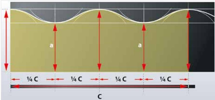
6. Mit dem Zirkelmaß des Radius des gedämmten Ventilkörpers sind zunächst zwei Kreise senkrecht auf dem oberen Endpunkt der Strecke **a** zu erstellen. (2. Und 4. Linie von links) Mit dem gleichen Radius ist nun von Linie 1,3 und 5 aus jeweils der Tangentialpunkt (Berührungspunkt) der ersten beiden Kreise durch Zeichnen von drei Kreisbögen zu ermitteln.
