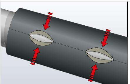
**Hinweis:** Damit sich die Klebenaht nicht wieder öffnet, ist sicherzustellen, dass der Kleber vollständig und in der korrekten Menge auf die Schnittflächen aufgetragen worden ist.
