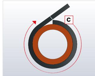
1. Den Rohrumfang und den Umfang des Abzweiges mit einem ArmaComfort Streifen ermitteln.
