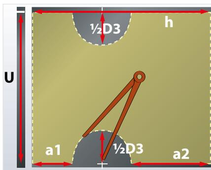
Die Maße **c**, **a1**, **a2**, **h** und **d** auf eine ArmaComfort Platte übertragen und das Formteil für den vertikalen Teil des Abzweiges ausschneiden.
