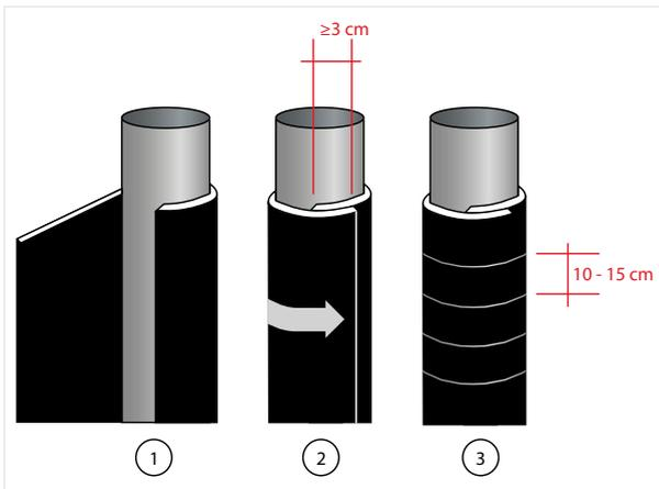
3. Zugeschnittene Platte im rechten Winkel am Rohr ansetzen und um die Rohrleitung legen. Abschließend die Platte mit Drähten im Abstand von 10 - 15 cm fixieren.
