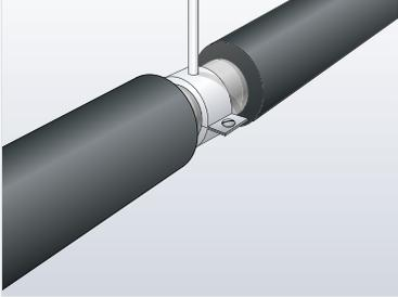
1. Die ArmaComfort Dämmung so dicht wie möglich an die Rohrschelle heranführen.
