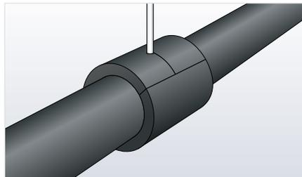
5. Dämmung um den Bereich der Schelle montieren und alle Nähte dicht verkleben, insbesondere den Durchbiegungsbereich der Gewindestange.
