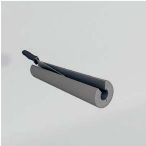
Bei größeren Dämmdicken empfehlen wir eine zusätzliche Schlitzung im Innenbereich von  $\frac{2}{3}$  der Dämmdicke.
