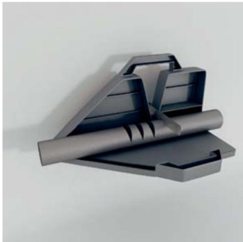
... und am rechten äußeren Punkt anfangen zu schneiden. In gleicher Position Gegenschnitt anbringen. Bei jedem weiteren Punkt genauso schneiden, ergibt 5 Segmentschnitte.
