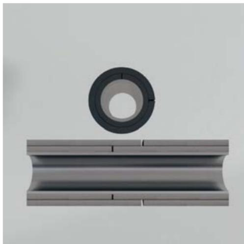
Bei mehrlagiger Dämmung ist darauf zu achten, dass die Klebenaht versetzt und an den Rohrenden die obere mit der unteren Lage verklebt wird.
