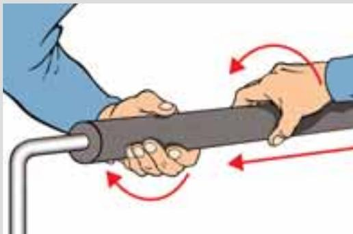
Um das Material nicht zu beschädigen, wird dieser Vorgang vereinfacht, indem man den Schlauch mit leichten Drehbewegungen über das Rohr führt. Besonders in den Bögen ist darauf zu achten, daß der Schlauch nicht unter zu starker Spannung steht. **2**
