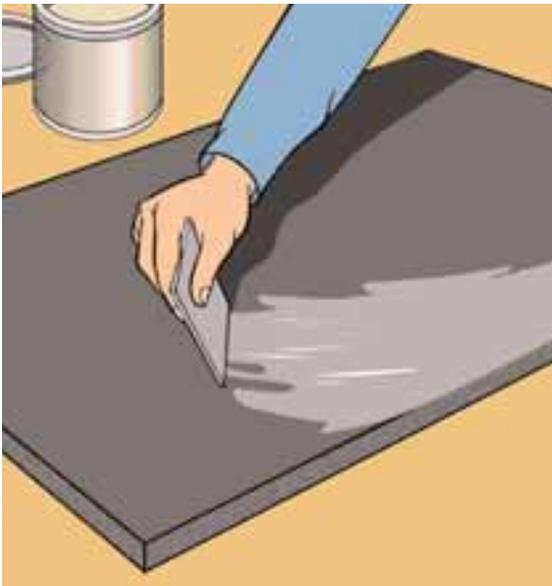
Zum Verteilen des Klebers auf große Flächen kann man einen Spachtel oder eine Lammfell-Rolle benutzen. Auch hier sollte der Kleber sparsam aufgetragen werden. Nach ausreichender Abluftzeit kann das Plattenmaterial auf die zu isolierende Fläche aufgebracht werden.
