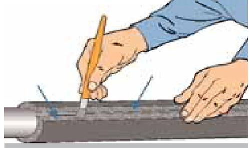
Kurze und nicht sehr dicke Schläuche können wie dargestellt aufgerollt und dann mit Kleber versehen werden. Somit kann der Schlauch leicht auf dem zu isolierenden Rohr aufgebracht werden.
