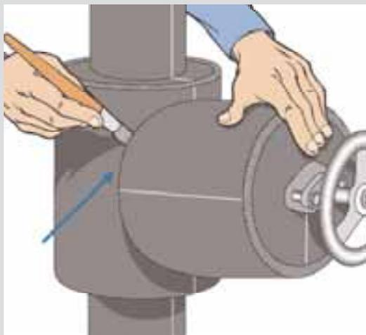
**26** Mit Pinsel und K-FLEX Kleber werden nun beide Bauteile verbunden.
