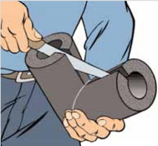
**4** Nach dem Ablüften des Klebers kann der Winkel in der Innenseite längs geschlitzt werden.
