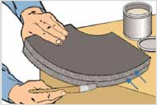
Nach der Abluftzeit klebt man die beiden Enden der Außenseiten..... **9**
