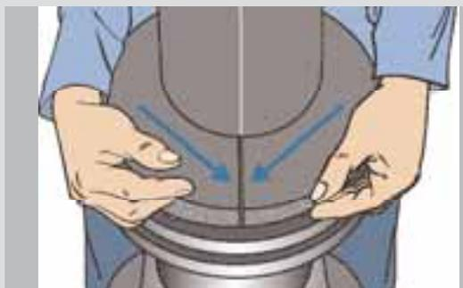
**5** Die ausgeschnittenen Ringe werden nun um das isolierte Rohr gelegt und die Schnittstellen verklebt.
