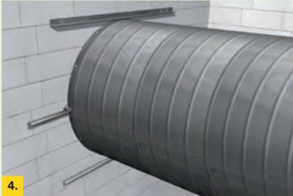
**4. Verstärkung des Kanals.** Schrauben Sie die Aufhängelaschen an beiden Seiten der Konstruktion an die Rohrleitung ( $c \leq 150$  mm). Lange L-Profile (30 x 30 x 3 mm) werden über und unter den Laschen mit je einer Niete ( $> 4$  x 13 mm) befestigt. Kurze L-Profile werden mit Muttern und Schrauben (M8) seitlich an den Laschenverschraubungen befestigt. Die Befestigung an der Wand erfolgt mit Wandankern/Dübeln. Die Profile sollen horizontal auf beiden Seiten des Bauteils angebracht werden.
