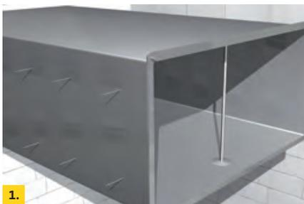
**1. Dämmung, Pins:** Setzen Sie am fertigen Kanal zur Befestigung der U Protect Slab 4.0 Alu1 und U Protect Slab 4.0 Brandschutzplatten geeignete Pins in einem Abstand von max. 260 mm zueinander. Damit Sie die Stöße dicht ausführen können, sollten die ISOVER Platten mit 5 bis 10 mm Überlänge/Überbreite geschnitten werden.
