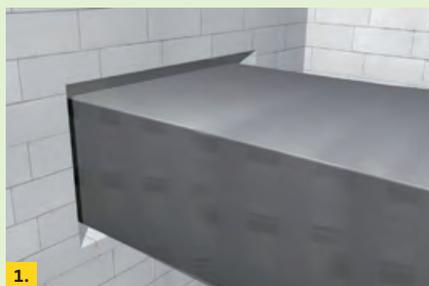
**1. Positionierung.** Positionieren Sie den Kanal in der Öffnung des Durchbruches, so dass der Abstand zwischen Kanal und Wandaibung 50 mm nicht überschreitet.
