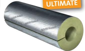
Mit der U Protect Pipe Section Alu2 bietet ISOVER eine innovative Rohrschale, die die Anforderungen der EnEV mit einem Rechenwert der Wärmeleitfähigkeit von  $0,035 \text{ W}/(\text{m}\cdot\text{K})$  in allen Dämmdicken erfüllt. Zudem ist die U Protect Pipe Section Alu2 nichtbrennbar, verfügt über einen Schmelzpunkt  $\geq 1.000 \text{ °C}$  und kann für Wand- und Deckendurchführungen von nichtbrennbaren Rohrleitungen ohne Produktwechsel eingesetzt werden.
