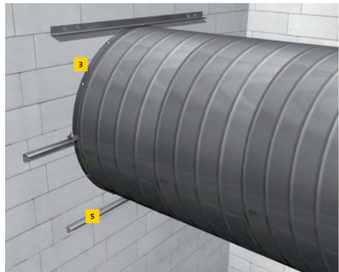
Senkrechte Lüftungsleitungen der Feuerwiderstandsklasse
