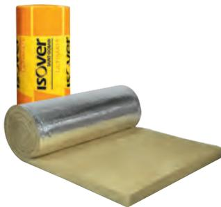
Mit dem **U Protect Roll 3.1 Alu1** Brandschutz-Filz bietet ISOVER eine neue R90/R120 Brandschutzlösung bei Deckendurchführungen von Gussrohren. Besonders für komplizierte Rohrleitungsführungen wie Schrägeinbauten, Abzweige, Bögen, Sammelleitungen oder auch Übergänge auf brennbare und nichtbrennbare Rohre ist das flexible, alukaschierte Produkt bestens geeignet. Zudem ermöglicht U Protect Roll 3.1 Alu1 eine einfache Verarbeitung und damit ein sicheres Ergebnis.
