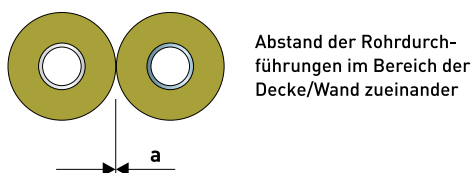
Montage der ROCKWOOL-Systemlösung R 90 im Wand- und Deckenbereich bei brennbaren und nichtbrennbaren Installationsrohren
